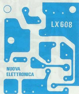
Fig. 3 Disegno a grandezza naturale del circuito stampato.
